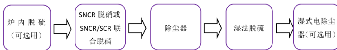
图 7.1.2-2 循环流化床锅炉的超低排放工艺流程图
